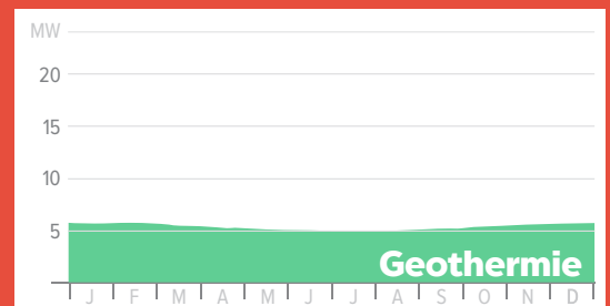
Abbildung 2: Jahresganglinien der Stromerzeugung von Photovoltaik und Wind im Jahr 2013 (Fraunhofer ISE, 2014) und dem typischen Jahresverlauf eines Geothermiekraftwerkes (grün) mit einer Leistung von 5 MW.
